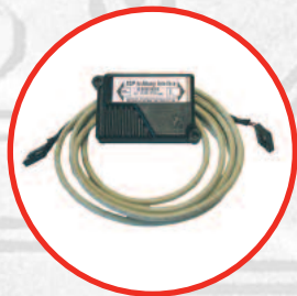
IF9 (interfejs prevodi SSP u binarni protokol) Za NV7 i novije
